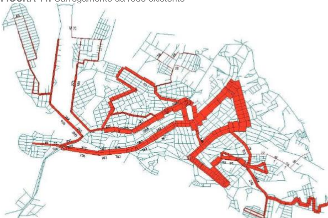
FIGURA 44: Carregamento da rede existente
